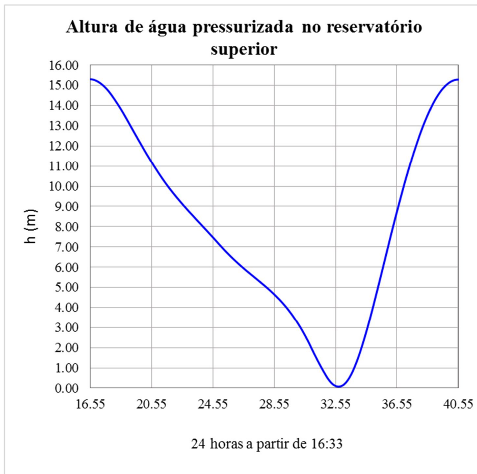
Figura 11-2: Simulação em Excel para a altura de água pressurizada no reservatório superior partindo de h_0=15,4\text{m} (próprio autor).
